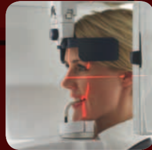
des spots d'alignement laser guident avec précision le positionnement du patient
