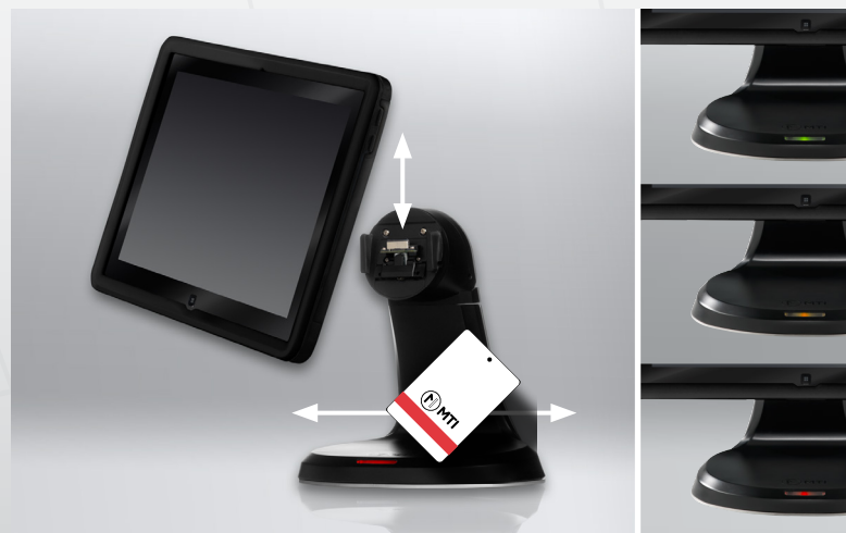
La carte RFID glisse sur la base pour libérer la partie mobile
